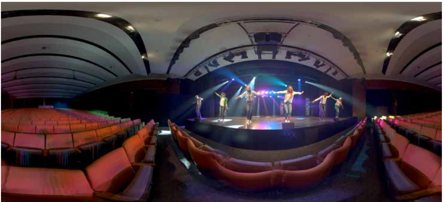
Fischaugen-Effekt: Jede der acht Linsen der 360-Grad-Kamera erzeugt ein Panoramabild. Die einzelnen Bilder werden im Stitching zusammengefasst, damit ein stereoskopisches Rundum-Bild und daraus ein Video entsteht
